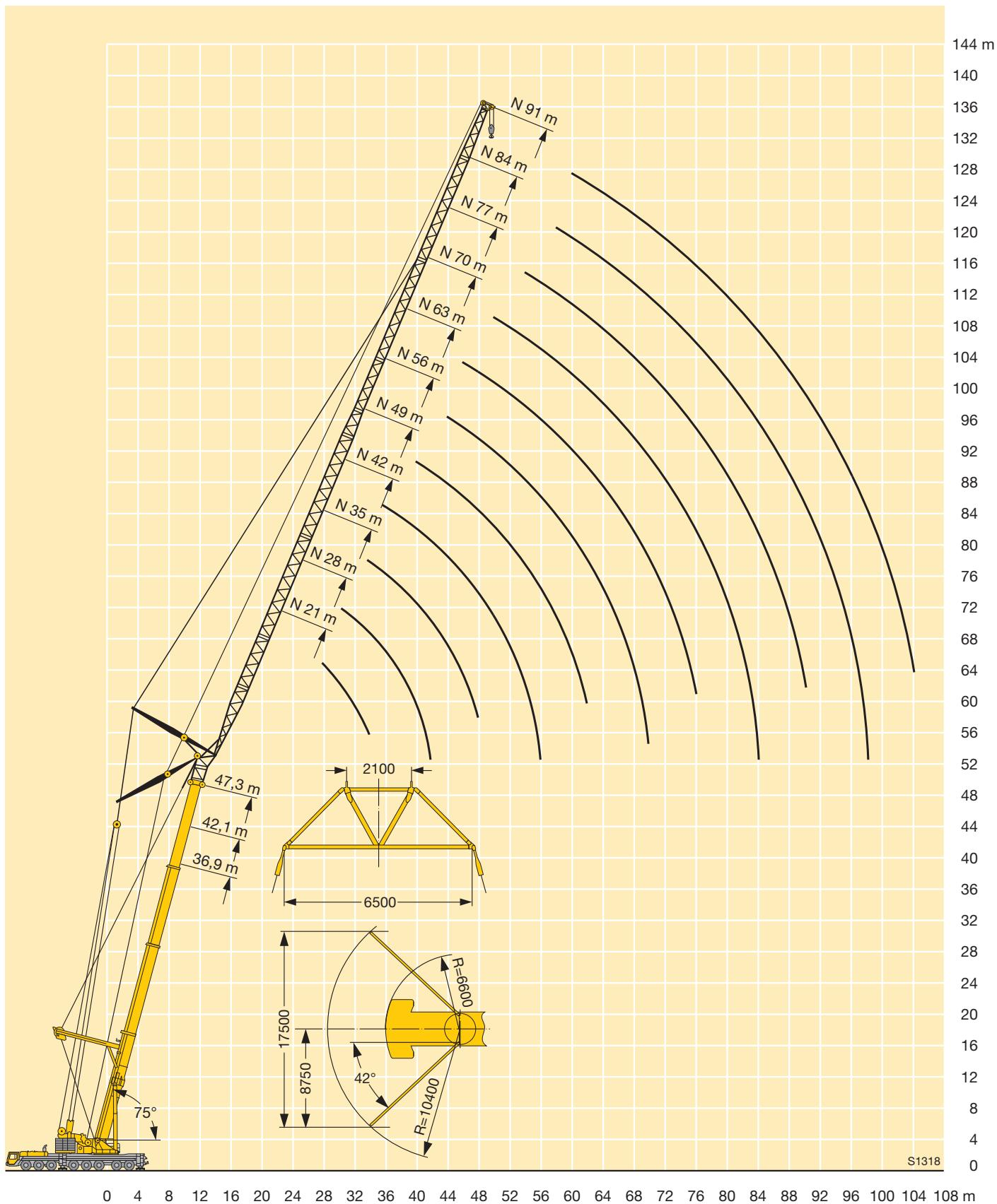
**Traglasten an der wippbaren Gitterspitze mit abgespanntem Teleskopausleger und Spacer**
