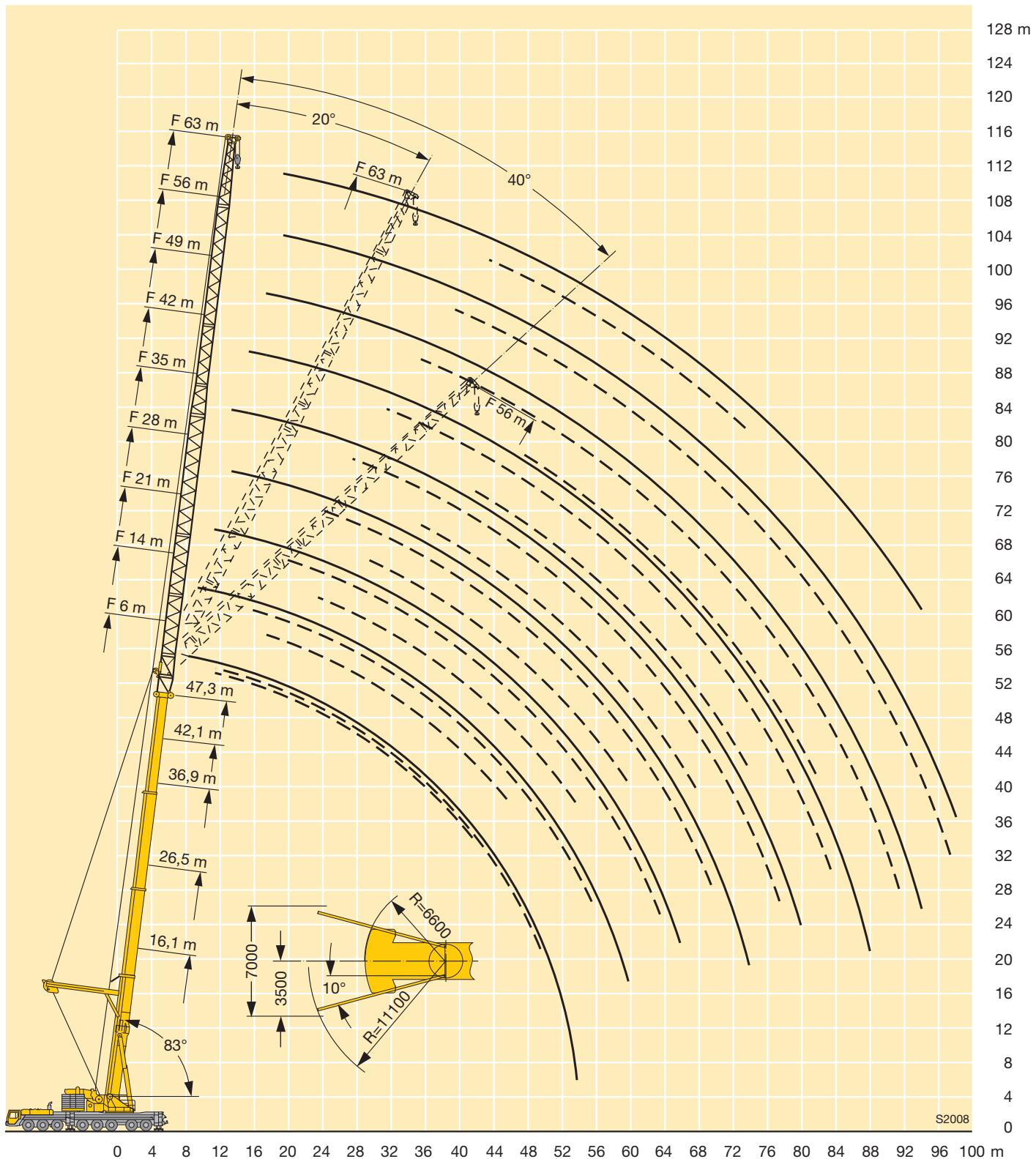
**Traglasten am abgespannten Teleskopausleger mit hydraulisch verstellbarer Gitterspitze und Exzenter**
