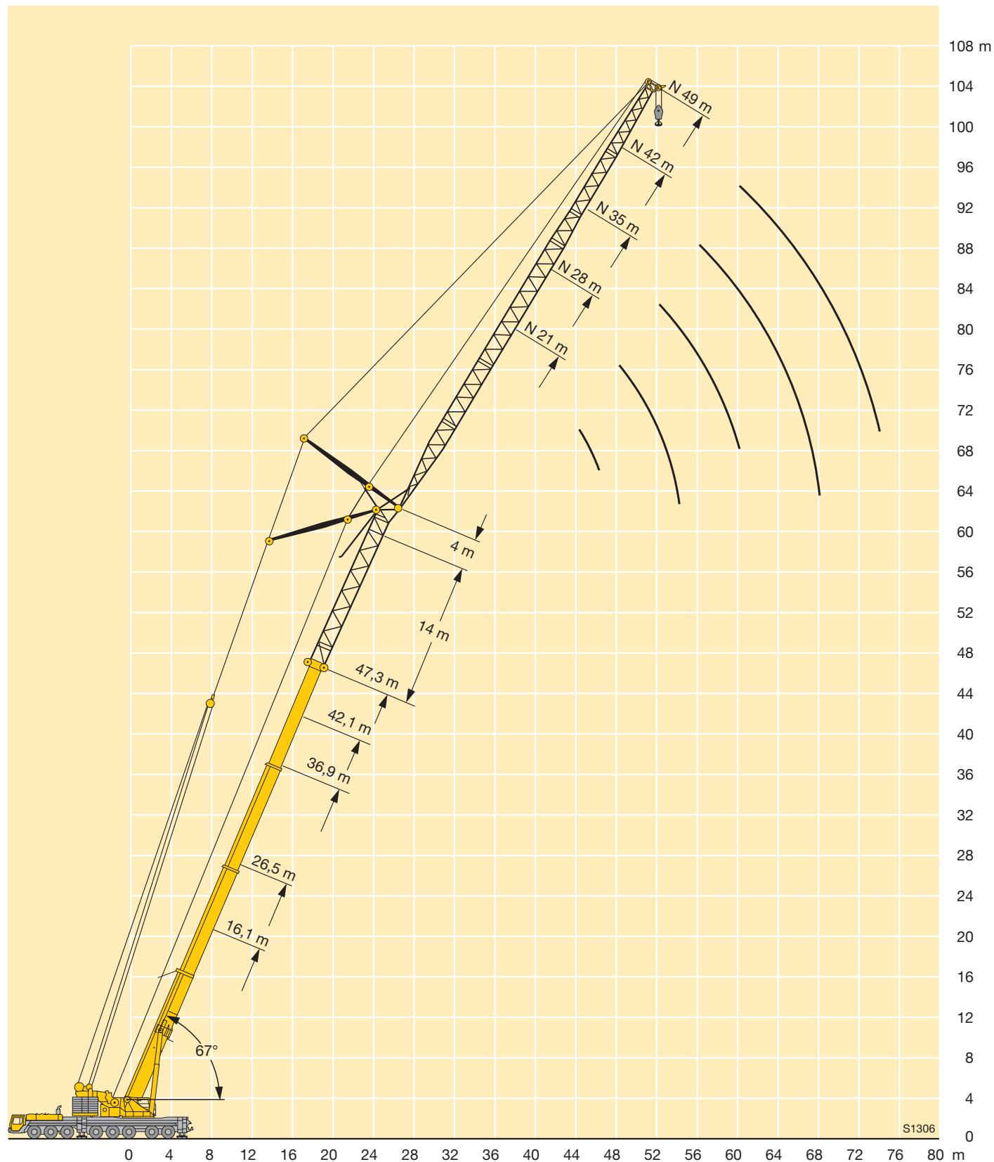
**Traglasten an der wippbaren Gitterspitze mit abgespanntem Teleskopausleger**
